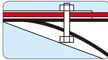
パイプの先端をくさび状につぶしてありますからパイプの中に雪が詰まらず、雪の抵抗も少なく、雪ささがりが良い。ダンプの底面と同じ角度ですから、きれいに除雪ができます。
