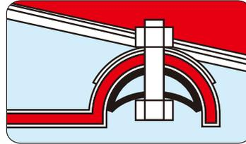
ポリカーボネート製先端パーツを本体先端の両サイドまではさみこむサンドイッチ構造(本体、先端パーツ、パイプをビスナットで1本に固定)にしてありますので耐久性に優れています。
